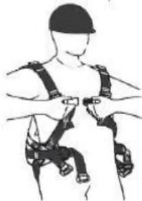
Den Gurt an der Rückenöse halten und durch leichtes auf- und ab Schütteln die Gurtbänder lockern.
