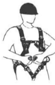
Den Haltegurt (Beckengurt) schließen und beidseitig festziehen. Hierbei darauf achten, dass die Steigschutzöse immer Mittig eingestellt ist.
