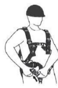
Die Beingurte durch den Schritt ziehen und an der Vorderseite mit dem passenden Gegenstück verschließen. Die Länge passend einstellen.
