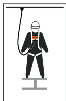
2 pętle zaczepowe na klatce piersiowej, oznaczoną symbolem „ \frac{1}{2} A”
