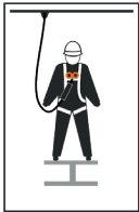
2 Auffangschlaufen im Brustbereich, bezeichnet mit "1/2 A"
