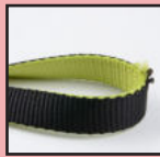
Bandkante kaputt / mehrere Schleifen gezogen
