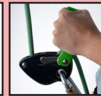
Ablassmechanismus funktioniert nicht
