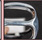
Seil läuft über scharfe Kante/Grat
