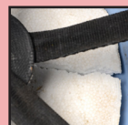
Bruch im Schaumteil
